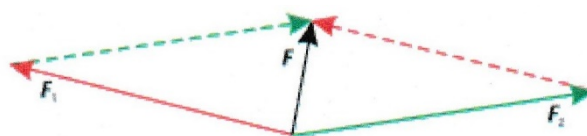
Рисунок 4.1 – Векторная сумма сил (параллелограмм сил)
