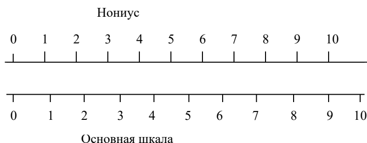
Рисунок 2.1 – Нониус и основная шкала
