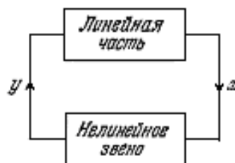
Рисунок 4.1.2 – Структурная схема нелинейной АСР
