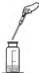
Рисунок 9. Соединение шприца-дозатора с пипеткой для титрования
