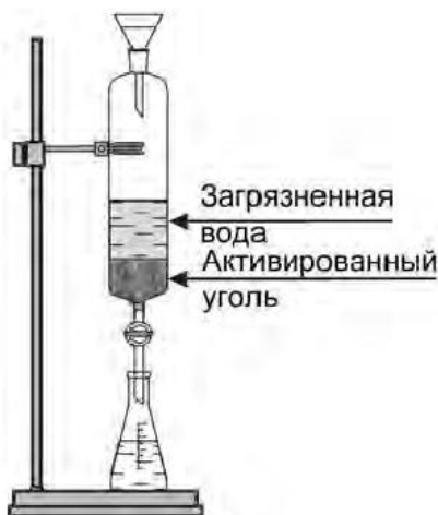
Рисунок 12. Установка для очистки воды адсорбцией
