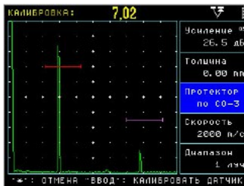
Рисунок 6.7 – Калибровка наклонного преобразователя по образцу СО-3
