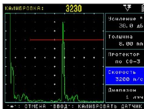
Рисунок 6.9 – Калибровка скорости в образце
